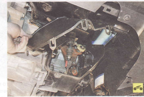
5. Снимите крышку кожуха механизма переключения передач (см. «Замена тросов управления коробкой передач», с. 137).
