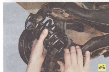
5. ...и снимите верхний рычаг задней подвески.
