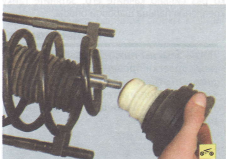
6. ...и снимите верхнюю опору стойки в сборе с буфером сжатия.
