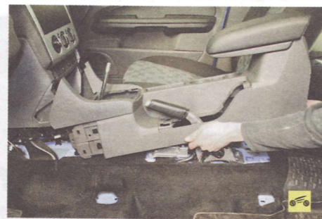
1. Снимите облицовку тоннеля пола (см. «Снятие и установка облицовки тоннеля пола», с. 261).
