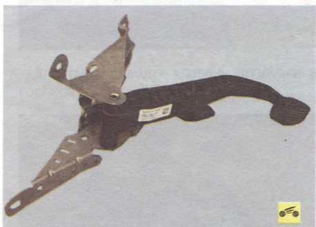
...и педали 5 сцепления, кронштейн 6 которой прикреплен гайками 4 к щиту передка кузова. В исходное положение педаль возвра-
