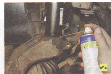
9. ...и смочите его проникающей смазкой типа WD-40 или ее аналогом.
