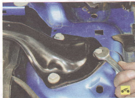
11. ...выверните три болта крепления амортизаторной стойки...
