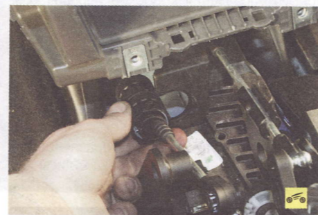
6. ...и извлеките упор оболочки из кронштейна кулисы рычага управления коробкой передач.
