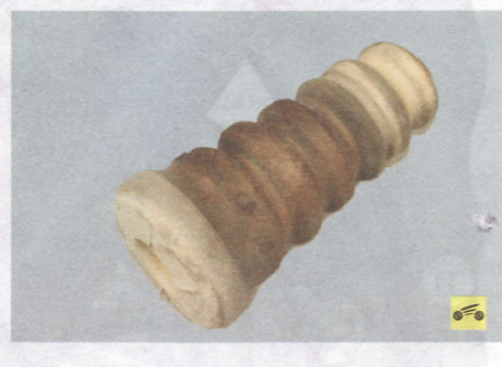
11. Осмотрите буфер сжатия. Затвердевший, потрескавшийся или деформированный буфер замените новым.
