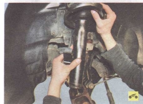
14. ...и снимите амортизаторную стойку. 15. Установите детали в порядке, обратном снятию.
