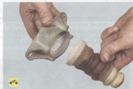
10. Разъедините буфер сжатия и кронштейн крепления амортизатора.
