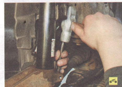
8. С помощью зубила и молотка разожмите клеммовое соединение...
