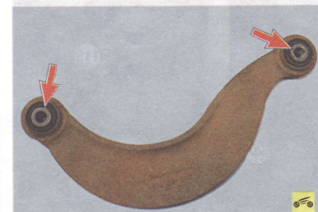
5. ...и снимите верхний рычаг задней подвески.
