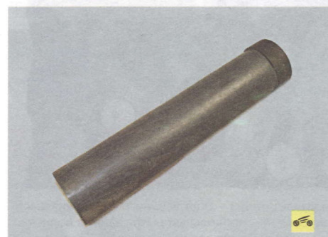
9. Осмотрите защитный кожух. Поврежденный кожух замените.
