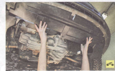
4. Снимите брызговик двигателя (см. «Снятие и установка брызговика двигателя», с. 86).
