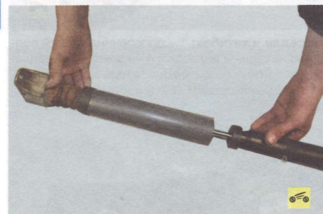
7. ...и снимите кронштейн в сборе с буфером сжатия и защитным кожухом.
